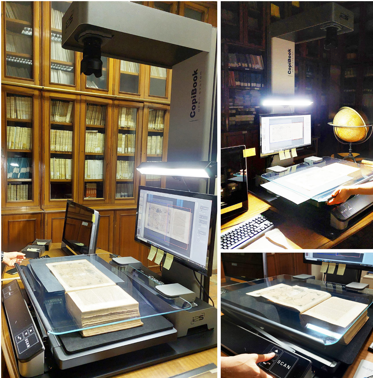
Figura 2. Fasi e specificità del processo di digitalizzazione di una carta geografica all'interno di un volume del patrimonio storico. A sinistra, la «Sala Lettura» della Biblioteca e lo scanner con l'obiettivo in alto, il piano basculante, il vetro, la luce led ; la sala completamente oscurata durante l'intero processo di scansione dei volumi con strumenti per rimuovere polveri dalle pagine, in alto a destra. La carta geografica ripiegata viene gradualmente appiattita grazie alla pressione del vetro per una scansione priva di distorsioni geometriche, in basso a destra. Fonte: foto di Maria Ronza e Vincenzo Giannoccaro.
