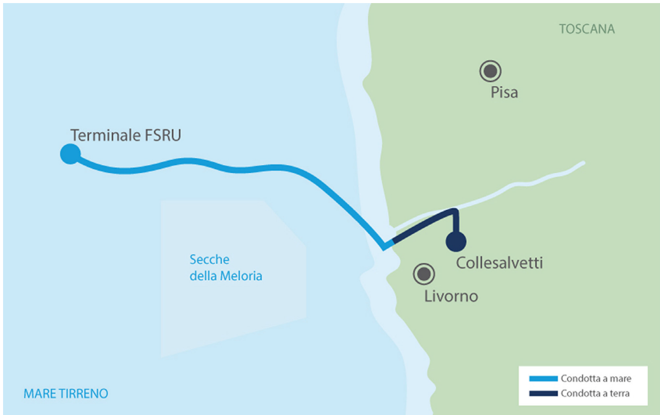
Figura 2. Rotta della condotta sottomarina e di quella a terra – la parte onshore ha una lunghezza di oltre 7 km – sino a Collesalveti. Fonte: www.oltoffshore.it/terminale/dove-si-trova .
